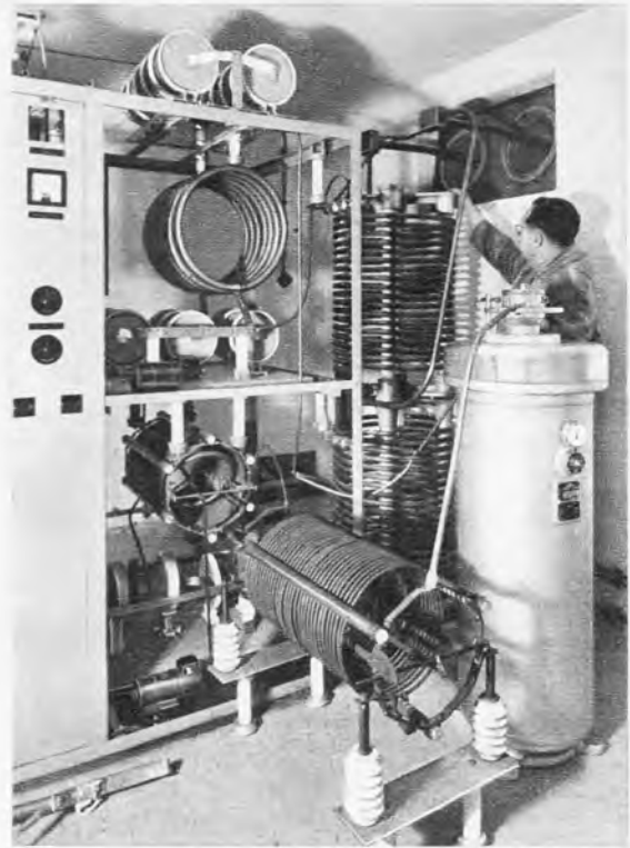
Links: Bild 8. Kühlwasserumlauf der Verdampfungs-(Siede-)Kühlung des 100-kW-Senders in Königslutter
