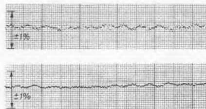
Bild 3. Gleichlaufschwankungen gemessen mit EMT 418, gehörig bewertet, Meßfrequenz 3 kHz. Oben: v = 9,5 cm/sec, \pm 0,25\% ; unten: v = 19 cm/sec, \pm 0,15\% . Vorschub des Schreibers 100 mm/sec
