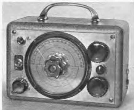
Bild 4. Frontansicht des Transistor-Einkreisers. Rechts neben der Skala liegen die Bedienungsknöpfe für Wellenschalter, Antennenkopplung und Rückkopplung (von oben nach unten), links Tonblende und Lautstärkeinsteller
