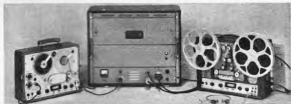
Bild 2. Piloton-Umspielanlage, bestehend aus dem Magnetbandgerät Reportofon MMK 6, dem Pilotonverstärkerkoffer und dem Magnetfilmgerät Reportocord 16 M/R
